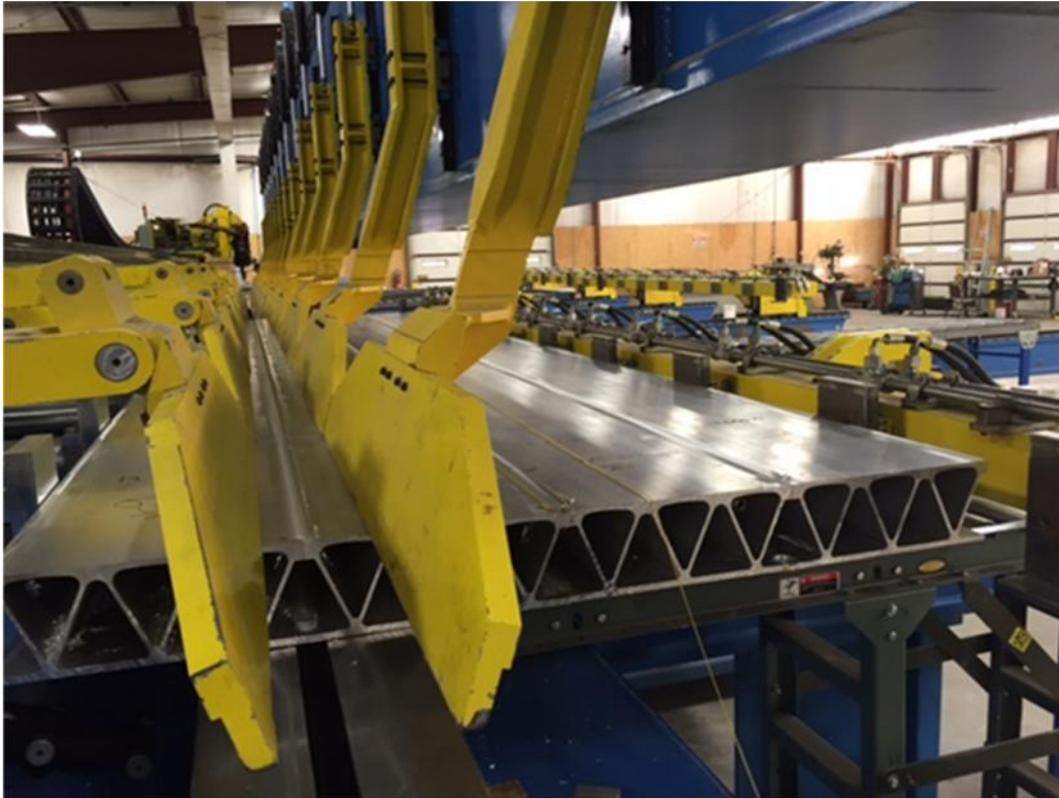
**Figure 5** – Soudage par friction-malaxage du platelage de 5 pouces
