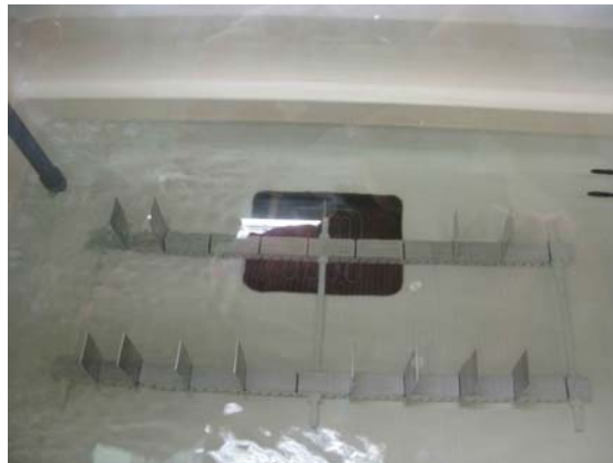
Figure 28. Échantillons disposés dans la chambre environnementale et immergés durant une des étapes d'un essai de corrosion cyclique.
