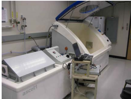
Figure 27. Chambre environnementale permettant d'exposer des échantillons et assemblages à des procédures de corrosion cyclique
